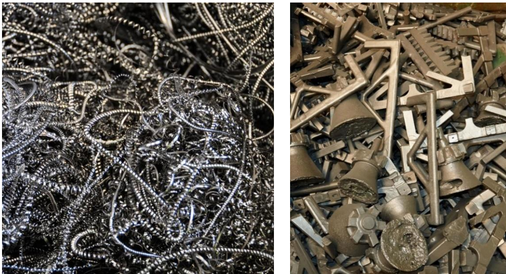
Figure 8 : Exemples des rebuts de production arrivant sur le site (process tournures à gauche et chutes à droite)
